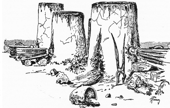
Rekonstrukce hutnické dílny vybavené šachtovými pecemi se zahlabenou nístějí (doba římská, Tuchlovice).
